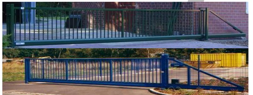
**Beschreibung:** Freitragende Ausführung, ohne Bodenlaufschiene, geführt von 2 Stück Rollenböcken im Spezial-C-Profil. Kugelgelagerte Kunststofflaufrollen sorgen für laufruhige und verschleißarme Torführung. Führungssäule mit Kunststofflaufrollen, Anschlagssäule mit Einlaufgabel und Auflaufschuh. Im Unterholm greift verdeckt eine Kombination von Zug- und Drucklagerböcken ein (C-Schiene).
